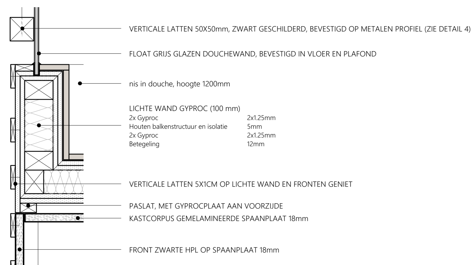
DETAIL 3: AFWERKING LATJES, schaal 1/5
